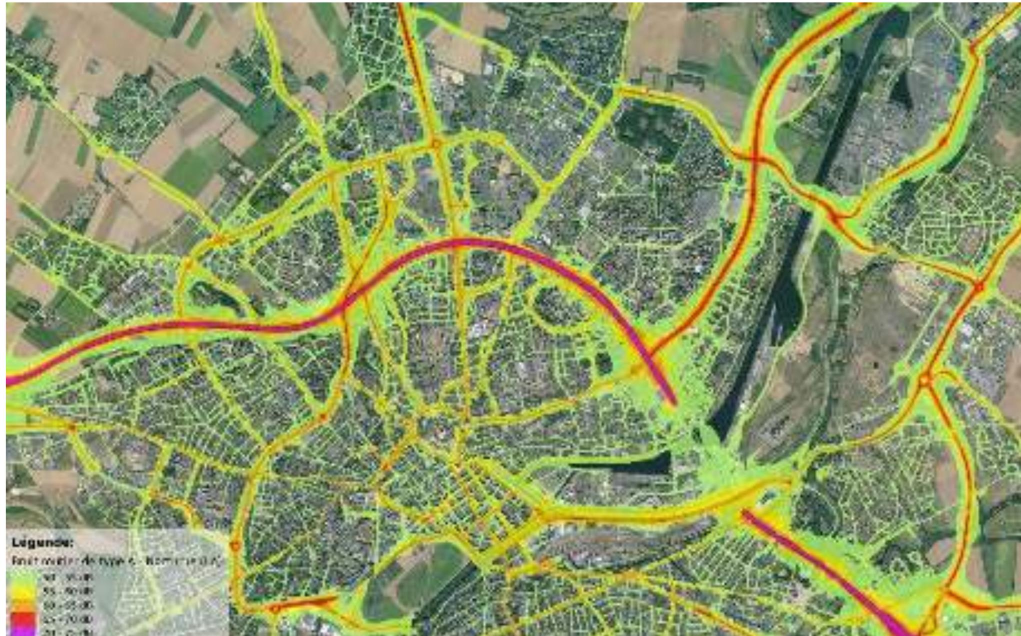
Figure 123 - Carte de bruit routier de type A de nuit (Source : <http://www.caenlamer/content/cartographie-du-bruit>)
