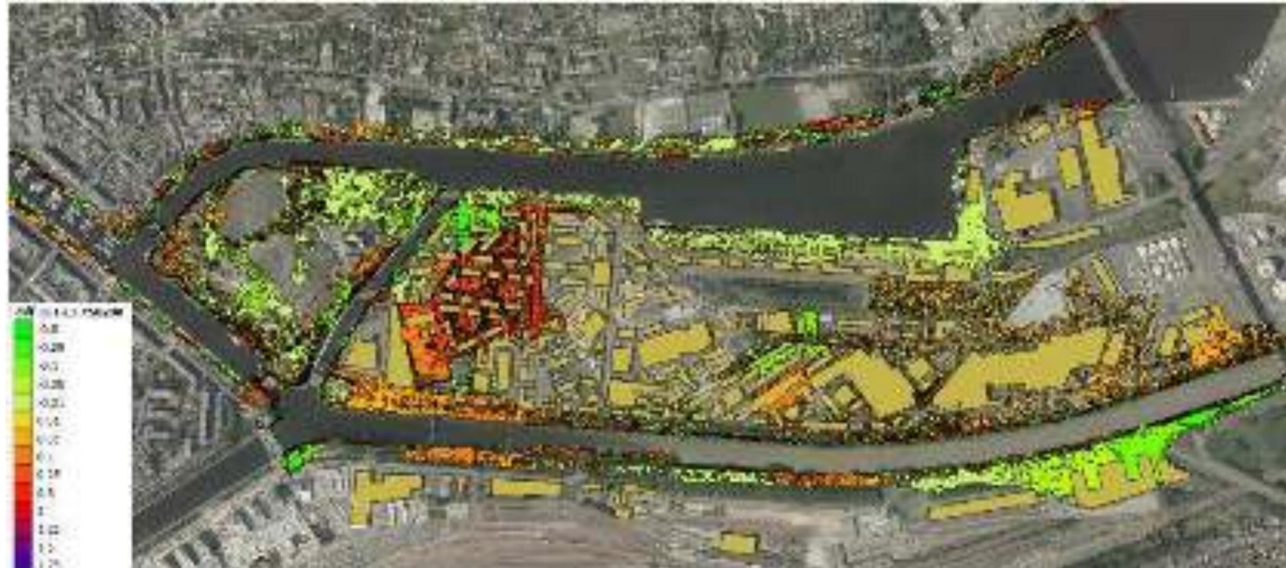
Figure 12 : Différences de hauteurs d'eau atteintes à l'état aménagé avec l'état initial au pic de la marée (16h00) (source : Etude hydraulique et gestion des EP dans le cadre du projet Caen Presqu'île – Mission 2 – SOGETI Ingénierie – Février 2017)
