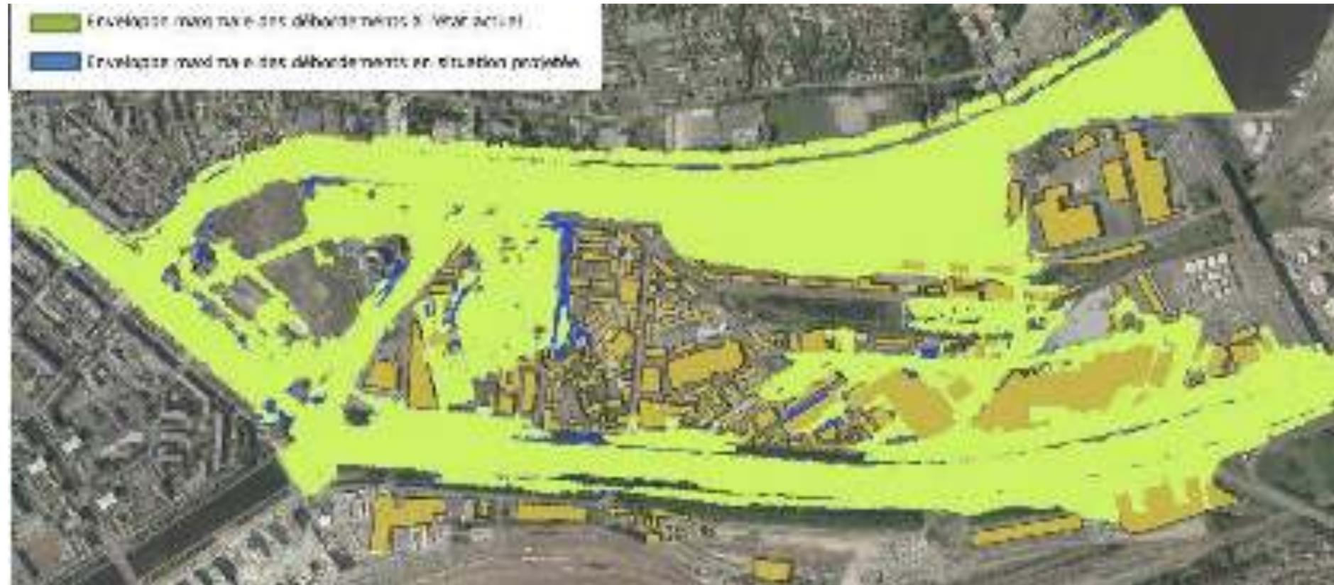
Figure 11 : Superposition de l'enveloppe des débordements à l'état initial avec l'état aménagé au pic de marée (16 h00) (source : Etude hydraulique et gestion des EP dans le cadre du projet Caen Presqu'île – Mission 2 – SOGETI Ingénierie – Février 2017)
