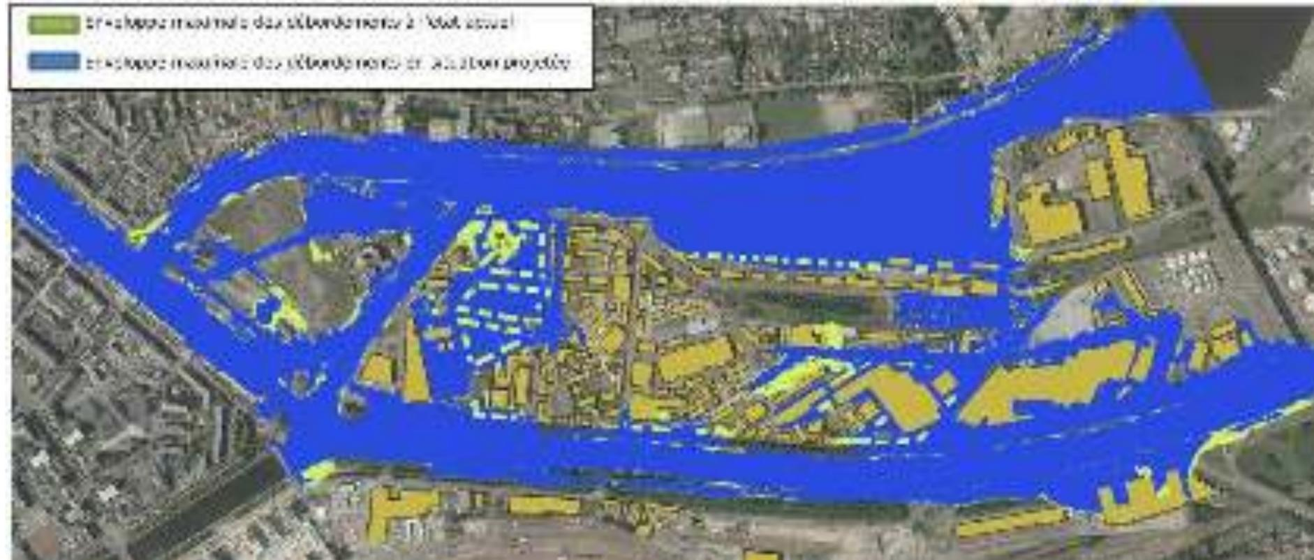
Figure 10 : Superposition de l'enveloppe des débordements à l'état aménagé avec l'état initial au pic de marée (16h00) (source : Etude hydraulique et gestion des EP dans le cadre du projet Caen Presqu'île – Mission 2 – SOGETI Ingénierie – Février 2017)
