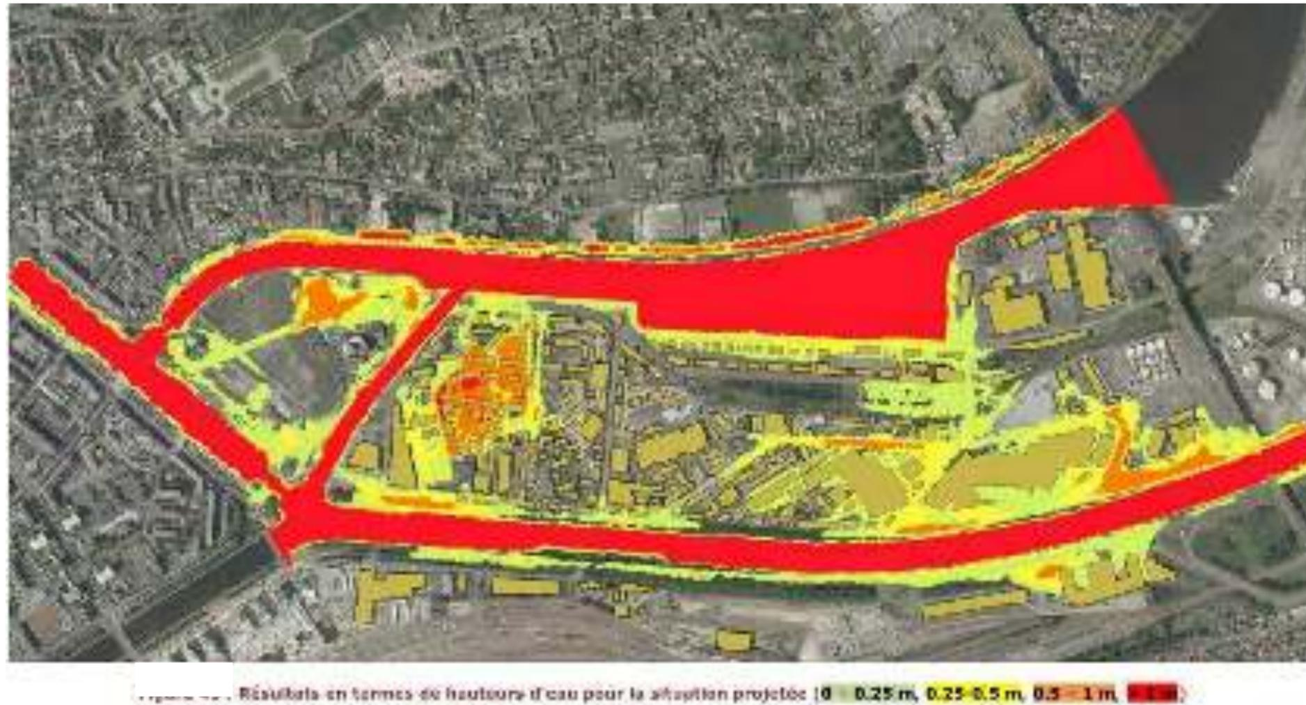
Figure 9 : Résultats en termes de hauteurs d'eau pour la situation projetée (source : Etude hydraulique et gestion des EP dans le cadre du projet Caen Presqu'île – Mission 2 – SOGETI Ingénierie – Février 2017)
