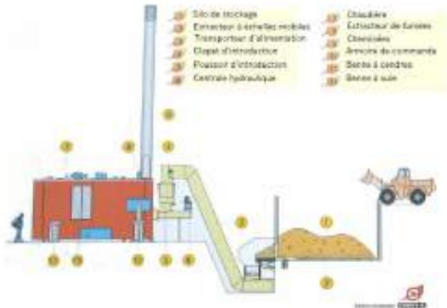
Figure 45 : Principaux éléments constitutifs d'une chaudière automatique à bois
