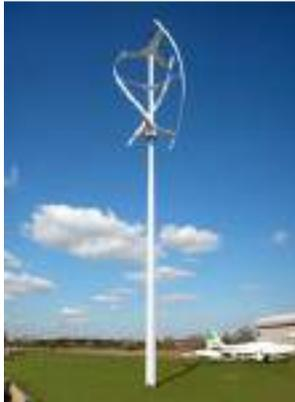
Figure 28 : Eolienne à axe vertical (Source : Quientrevolution)
