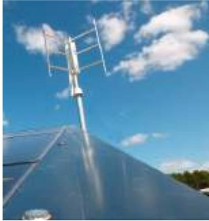
Figure 27 : Petite éolienne à axe vertical de type Darrieus (Source : Anemoos)
