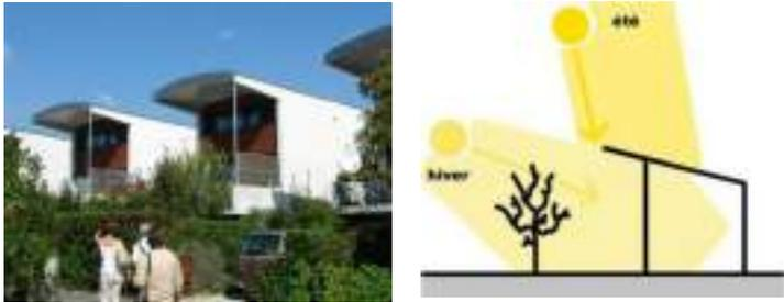
Figure 32 : Illustration du principe du pare soleil
