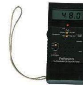
**Figure 19 : Détecteur d'ultrasons Pettersson D240x utilisé pour l'écoute et l'identification des chauves-souris en mode actif**
