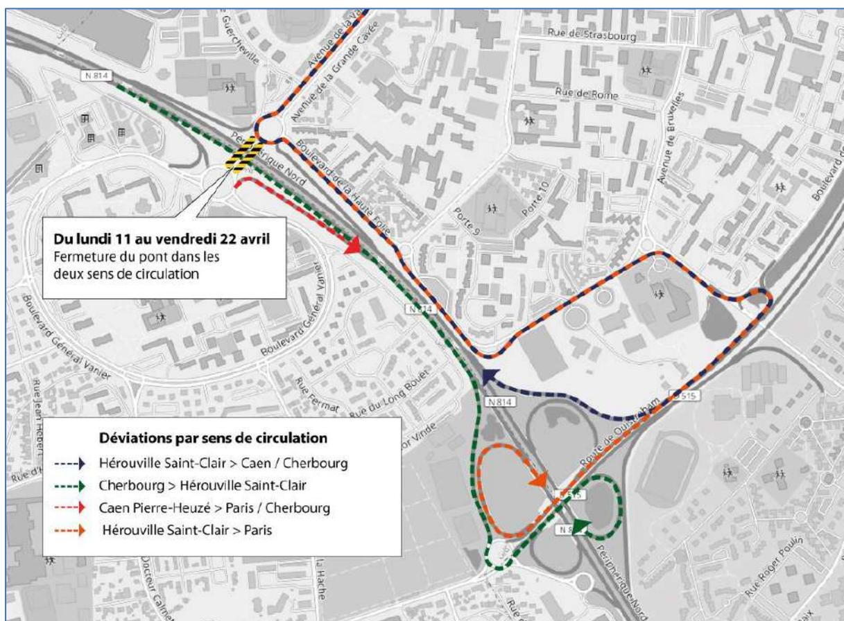
Cette nouvelle étape nécessitera, dans un premier temps, de fermer le pont à la circulation automobile pour réaliser les travaux d'élargissement des trottoirs et créer les deux pistes cyclables de chaque côté du pont. En parallèle, les joints de dilatation du pont seront renouvelés : ce dispositif permet d'assurer la continuité de l'ouvrage d'art avec les voies de circulation tout en garantissant son étanchéité.
